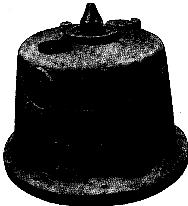
Рис. 3. Накладная головка для фрезерования колес наружного зацепления пальцевой фрезой.
